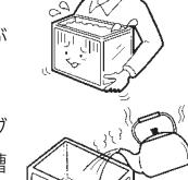
●水や砂利、岩などが入った状態では、水槽を移動させないでください。水槽が変形して水漏れが発生したり、水槽が割れる原因になります。
