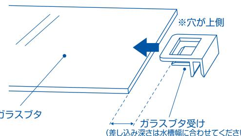
2. ガラスブタ受けが装着された状態で、ガラスブタ受けの溝部分を水槽側面ガラスに差し込んでください。
