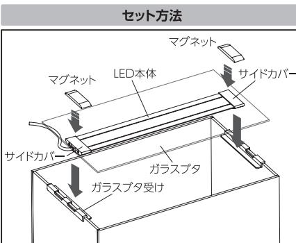
図のようにLED本体サイドカバーとマグネットの間にガラスブタを挟んで磁力で固定させてください。
