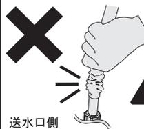
接続部の隙間をなくすために、接続部は必ずホースバンドでしっかり固定してください。ホースバンドを使用しないと、水漏れや抜けの原因になります。
