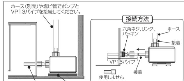
フィルターの吐出口にVP16パイプ(別売)を差し込み、付属の六角ネジを外側からVP16パイプに通し締めこみます。次にVP16パイプとポンプの吸水口を接続します。(この時ポンプと径が違う場合は異径ソケット(別売)をご使用ください。また付属のキャップは使用しません。)
