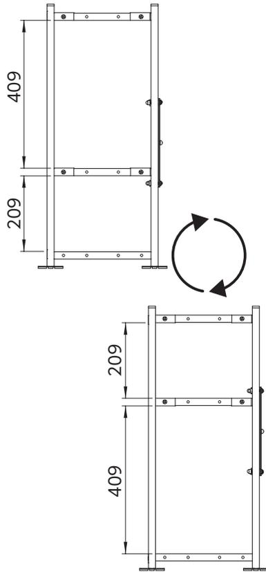
**棚の奥行き** 棚の組付け位置を変えることにより、スリムタイプの水槽の設置にも対応。上段棚板と下段棚板でパターンを変えれば数通りの組立が可能。
