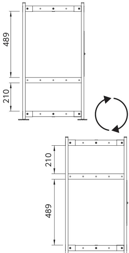
**棚の奥行き** 棚の組付け位置を変えることにより、スリムタイプの水槽の設置にも対応。上段棚板と下段棚板でパターンを変えれば数通りの組立が可能。
