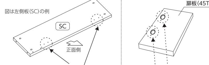
左開きの場合は右側板(SD)に右開きの場合は左側板(SC)にヒンジベースを2箇所に取り付けてください。
