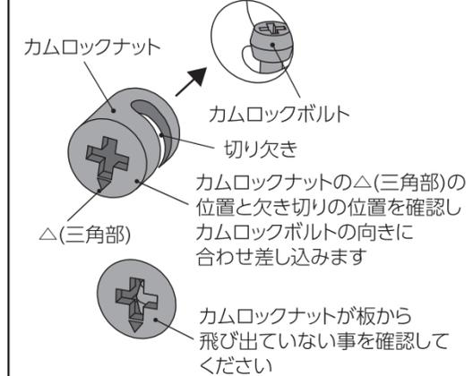
2.プラスドライバーでカムロックナットを時計回りに約180°回してしっかり締め付けてください。
