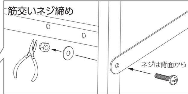
仮固定後に締め込む際は、プラスドライバーに加えペンチやスパナ等を併用し、締めてください。
