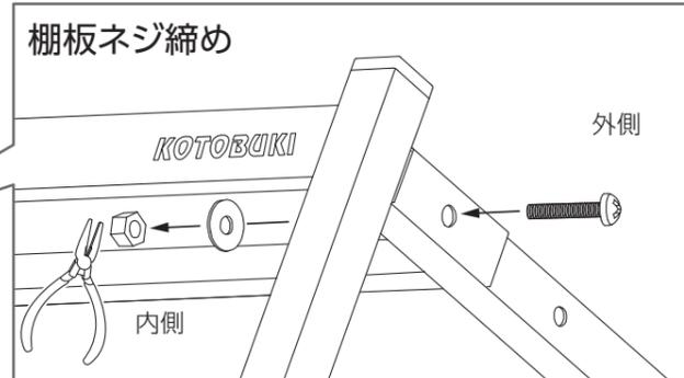
仮固定後に締め込む際は、プラスドライバーに加えペンチやスパナ等を併用し、締めてください。
