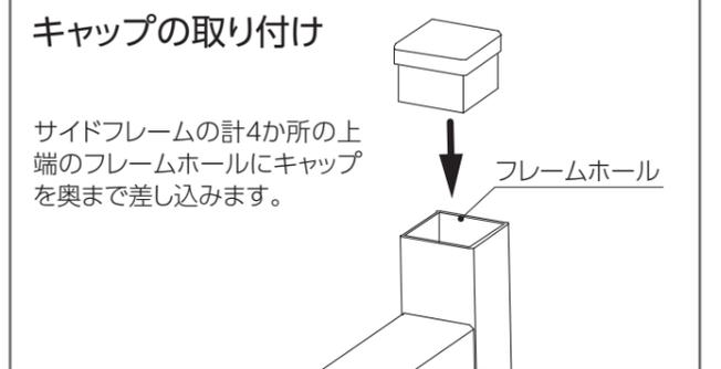
サイドフレームの計4か所の上端のフレームホールにキャップを奥まで差し込みます。
