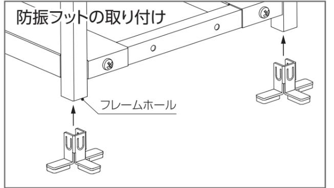
サイドフレーム下端の計4か所のフレームホールに防振フットを奥まで差し込みます。防振フットは3本の脚が図の様に外側に向くように取り付けてください。(内側の向きでは防振効果は出ません。)
