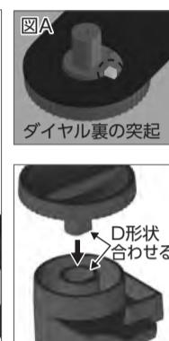
ダイヤルをメッシュの穴(表側から)に通します。ダイヤル裏の小さな突起がメッシュの穴の切り欠きに入るようにしてください(図A)。ロック及びスペーサーはメッシュの裏側から取り付けます。ダイヤル、ロック、(スペーサー)を互いにしっかりと奥まで差し込んだ後、ネジ(大)を使用しプラスドライバーで最後までしっかりと締め込んでください。(注意:ドライバーはネジに押し付けるように回してください。また先端が細いドライバーを使用するとネジ山が潰れやすくなります。)
