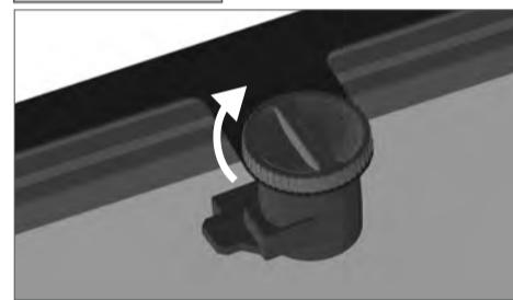
ダイヤルを「CLOSE」の方向に90度回すとロックが回転し水槽の枠に固定されます。すべての箇所のダイヤルを固定してください。※取り外すときは反時計回りに「OPEN」の方向に90度回してください。
