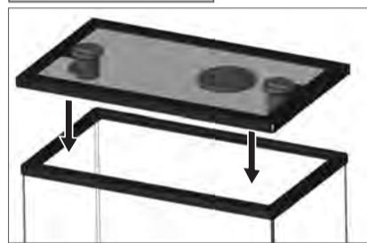
部品の取り付けが完了したアタッチメッシュを水槽枠の上に被せます。(ダイヤルはOPENに回した状態で被せます)
